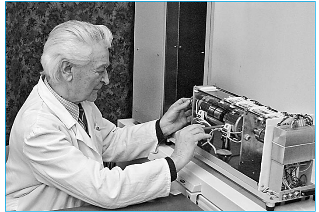
Prof. Krempaský a jeho aparátúra na pulzné meranie tepelnej vodivosti, za ktorú dostal v roku 1989 Národnú cenu za rozvoj metód merania
