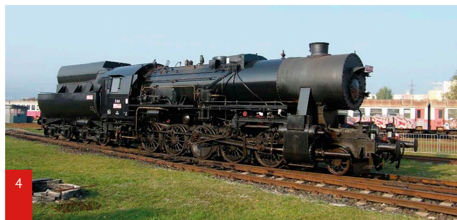
← Parný rušeň 555.3008 s tendrom 930.3020 (r. v. 1943, výrobca Škoda) je dvojvalcový dvojčlenný nákladný parný rušeň na prehriatu paru s olejovým vykurovaním. Patrí medzi približne 6 500 nemeckých vojnových rušňov radu 52 DR vyrábaných počas II. svetovej vojny prakticky všetkými lokomotívkami okupovanej Európy. (foto vľavo)
